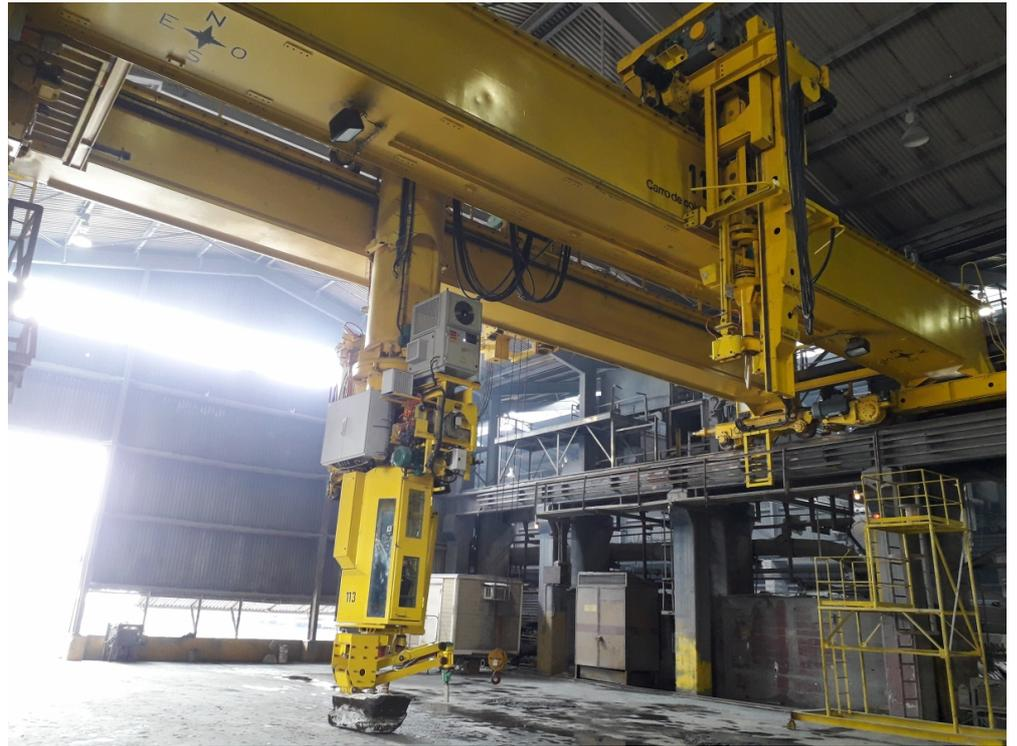
Machine de service en électrolyse remise à neuf
