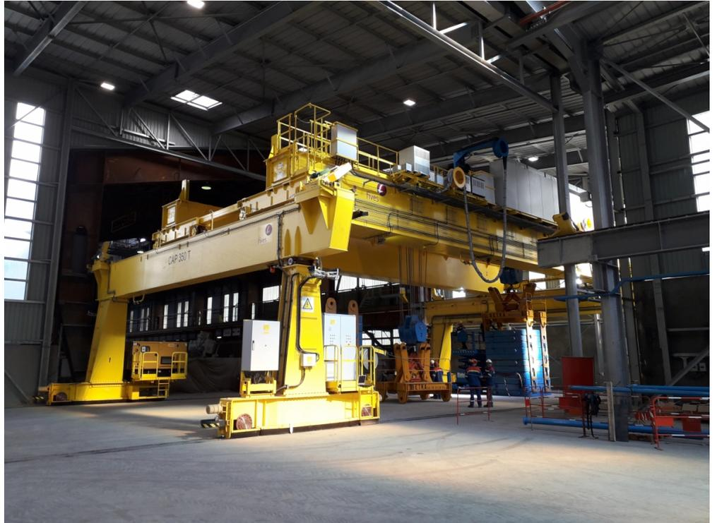
Machine à transporter les cathodes et son transbordeur durant son essai en charge à 276 to
